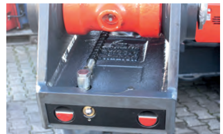
Abb. 8: Sperrventil für Verriegelungszyylinder
