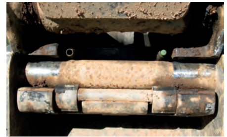
Abb. 5: Aktives Sicherungssystem an der Aufnahmeachse
