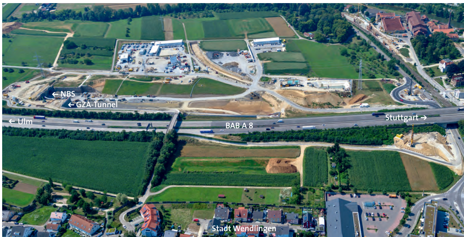
Abb. 2: Baustelleneinrichtung des Albvorlandtunnels für die Auffahrt von der Westseite (bei Wendlingen)
