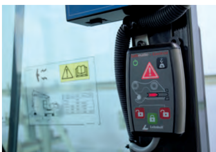
Abb. 4: Verriegelungsanzeige am Fahrerplatz
