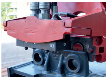
Abb. 3: Verriegelungsbolzen klemmt gegen Aufnahme
