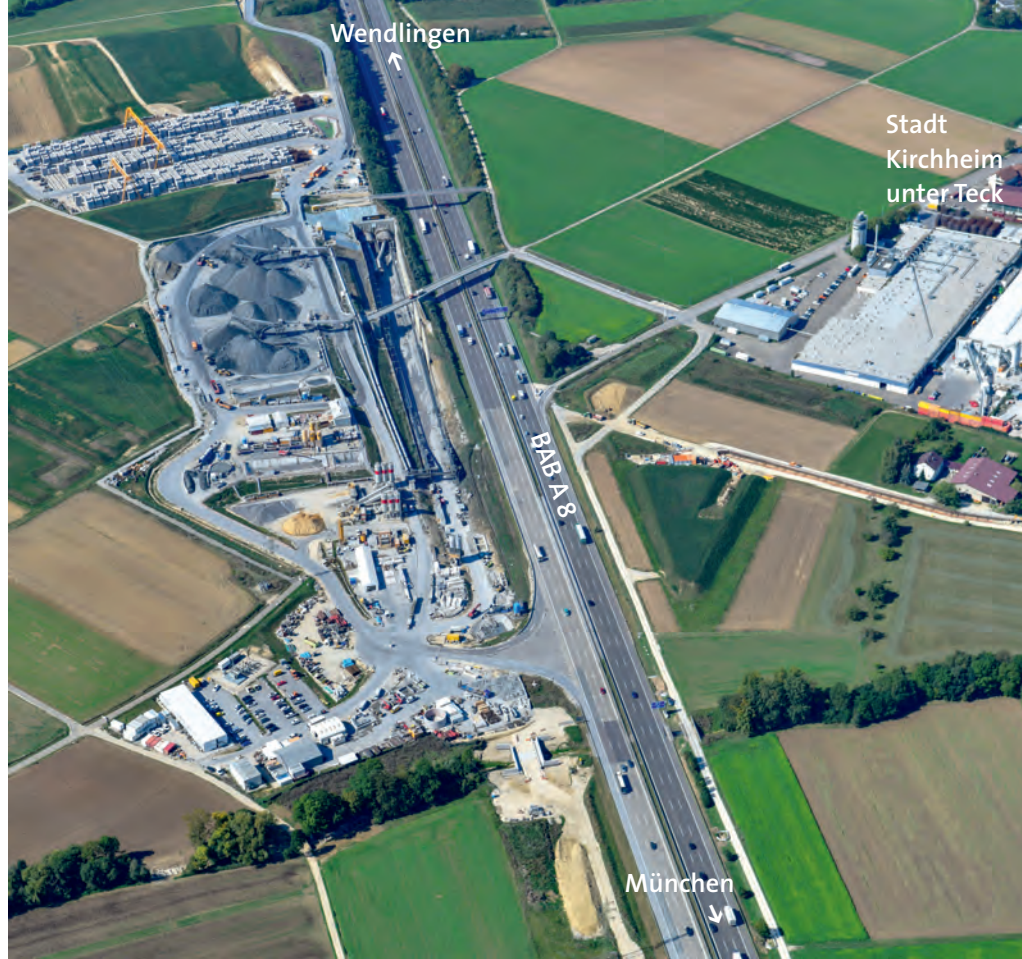
Abb. 3: Baustelleneinrichtung des Alvorlandtunnels für die Aufföhren von der Ostseite (bei Kirchheim unter Teck)
