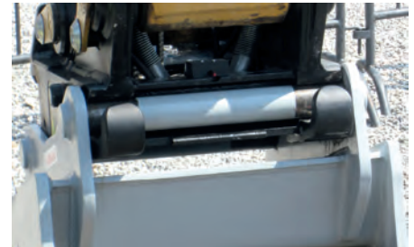
Abb. 6: Passives Sicherungssystem an der Aufnahmeachse
